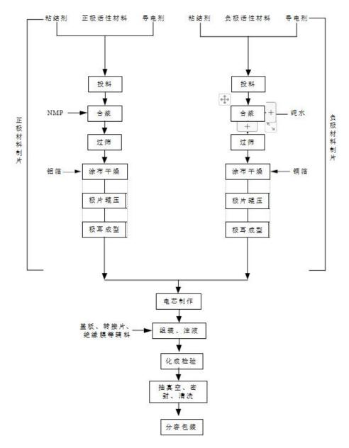
图 3-1 产品生产工艺流程图
